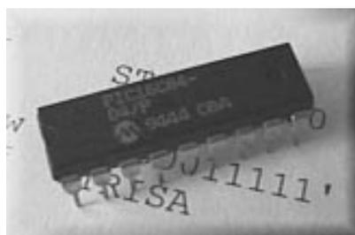
o PIC (neste caso um PIC16F84) pode ser visto externamente como um circuito integrado TTL ou CMOS normal, mas internamente dispõe de todos os dispositivos típicos de um sistema microprocessado, ou seja:
